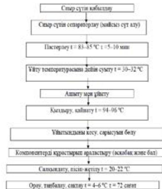
Сурет 1 – Ұлттық қызыл ірімшіктің жасау технологиялық сызбасы
