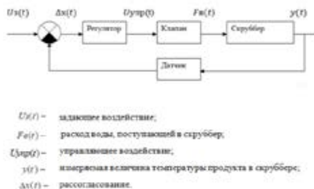
Рисунок 2 – Функциональная схема САУ температуры
